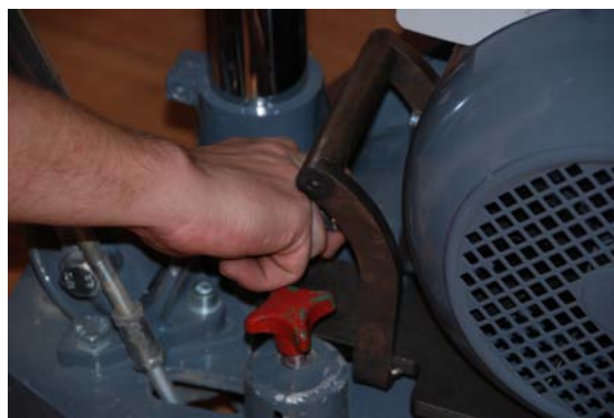
Visser - Desserrer la poignée arrière moteur
